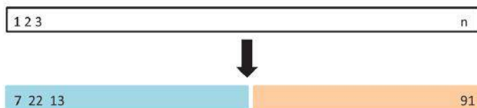
РИСУНОК 5.1. Схематическая иллюстрация метода проверочной выборки. Набор из n наблюдений случайным образом разбивается на обучающую выборку (показана голубым цветом и содержит наблюдения 7, 22 и 13) и проверочную выборку (показана бежевым цветом и, помимо других наблюдений, содержит наблюдение 91). Статистическая модель подгоняется на обучающей выборке, а ее качество оценивается на проверочной выборке
