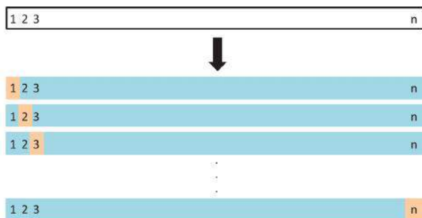
РИСУНОК 5.3. Схематическое изображение метода LOOCV. Набор из n наблюдений многократно разбивается на обучающую выборку (показана голубым цветом), содержащую все наблюдения, кроме одного, и проверочную выборку, которая содержит только одно это наблюдение (показана белым цветом). Ошибка на контрольном множестве затем оценивается путем усреднения n получающихся MSE. Первое обучающее подмножество содержит все наблюдения, за исключением первого, второе обучающее подмножество содержит все наблюдения, за исключением второго, и т. д.
