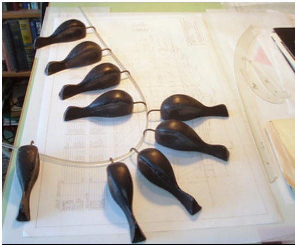
Рис. 4.11. Сплайны первоначально создавались на основе деформируемой древесины и "уток" и использовались в качестве инструмента чертежника для подгонки кривых. Фото с разрешения Боба Перри (Bob Perry)
