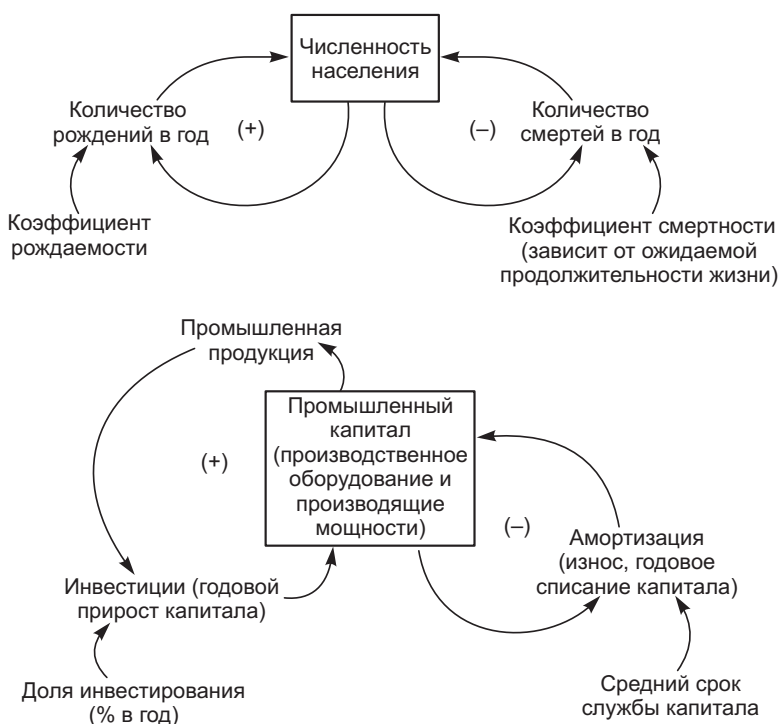
Рис. 4.4. Циклы обратных связей, определяющих рост численности населения и капитала
