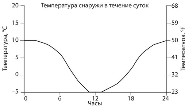
Изменение температуры снаружи — от  $10\text{ }^{\circ}\text{C}$  днем до  $-5\text{ }^{\circ}\text{C}$  ночью в течение 24 часов
