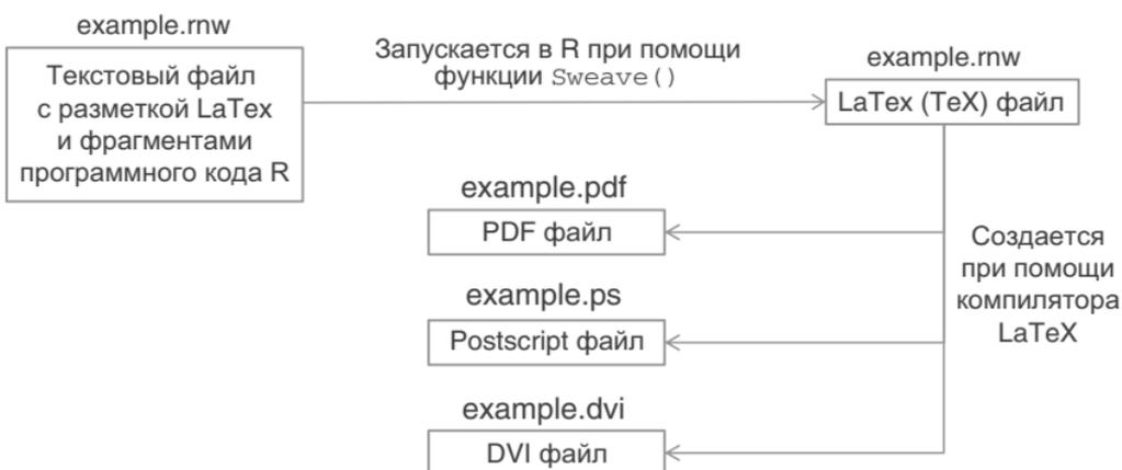
**Рис. D.1.** Процесс создания отчета типографского качества при помощи пакета `Sweave`
